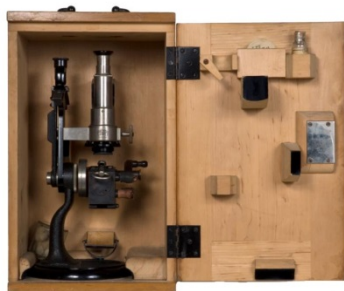
2T053 Refractómetro de Abbe (1911-1920)
