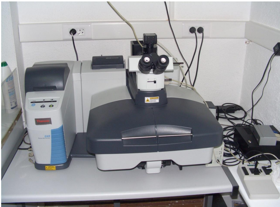
Figura 6. Microscopio Raman hiperespectral confocal del Museo Nacional de C. Naturales.
