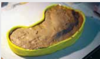
5 Aplicación de una cama rígida, con resinas de poliéster o espuma de poliuretano, para que el molde sea rígido.
