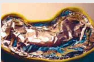
3 La silicona se aísla con papel de aluminio, para iniciar el proceso siguiente.
