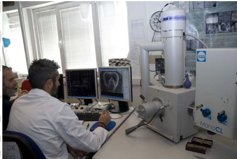
Microscopio Electrónico de Barrido FEI Inspect con presión controlada y sondas de EDSY CL
