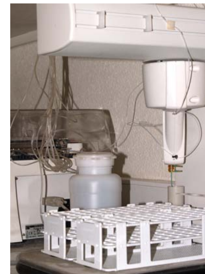
Sistema de análisis automático del analizador de flujo segmentado/Salvador Sánchez
