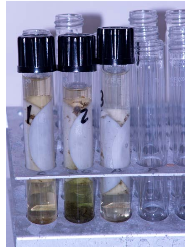
Extracción de la clorofila-a de las algas de un lago con metanol / Salvador Sánchez
