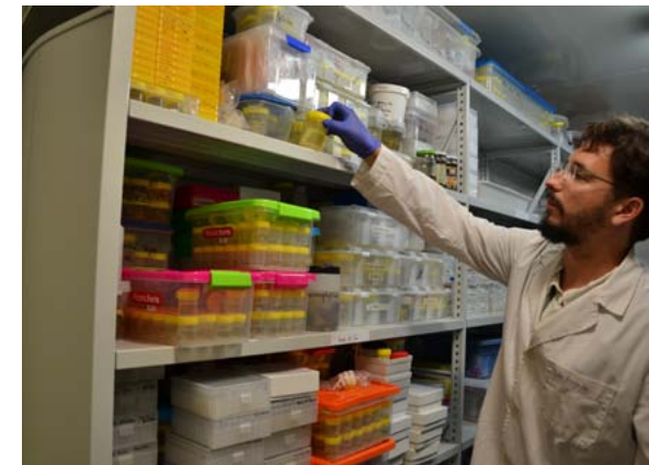
En el laboratorio se conservan las muestras de estudio en etanol absoluto a 4°C/ Xiomara Cantera
