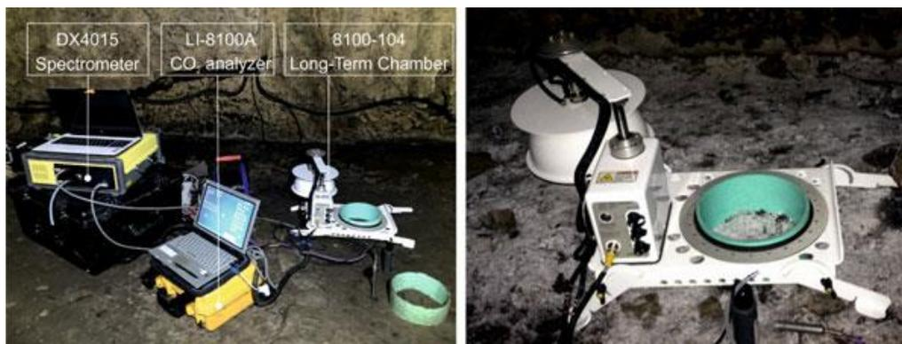
El equipo de medición in situ de flujos de intercambio de gases de efecto invernadero entre los sedimentos bicolonizados y la atmósfera subterránea. El sistema combina en serie las cámaras de medición de intercambio de gases y espectrómetros con tecnologías Cavity Ring-Down (CRDS) y de infrarrojos por transformada de Fourier (FTIR), ubicadas en diferentes puntos de la cueva. / Soledad Cuezva - Sergio Sánchez Moral
