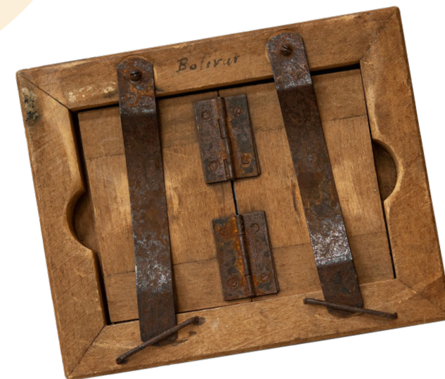
Prensa de contactos de fotográficos para reproducir fotografías en papel, c. 1900
