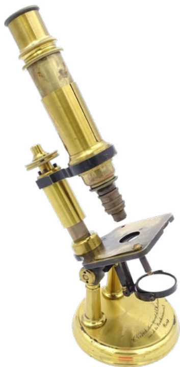
Microscopio de la firma francesa Constant de Verick, c. 1850. Destaca su estativo con pie redondo y doble pilar (ICH.0604) / E. Moreno
